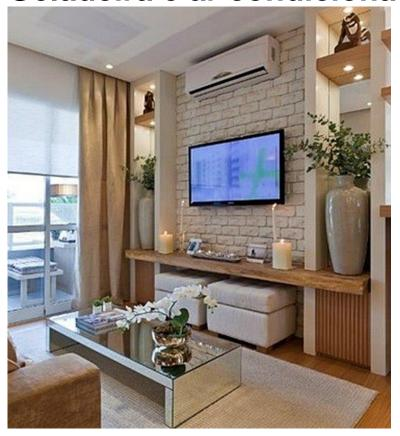
Aquecer líquido ou gás: colocar o aquecedor <u>embaixo</u>. Ex: lareira Resfriar líquido ou gás: colocar o refrigerador <u>em cima</u>. Ex: ar condicionado
